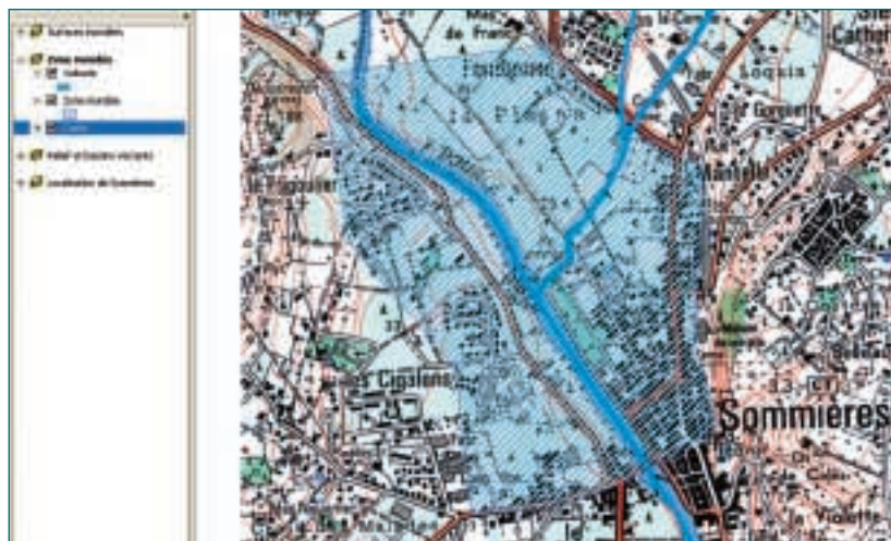
Limites de l'inondation d'après les relevés GPS.
